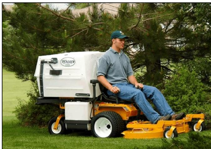
**UNA MÁQUINA COMPLETA SE COMPONE DE UNIDAD WALKER + PLATO DE CORTE DISPONIBLE POR SEPARADO**
