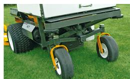
**7420-3:** Kit separador de ruedas pivotantes traseras (no incluye las ruedas); mejora la estabilidad en laderas y evita la marca de la rueda central
