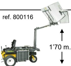
**A21:** Doble función hidráulica, para descarga basculante o en altura sobre camión o remolque; levanta, desplaza y vacía a una altura de hasta 1'70 m.
