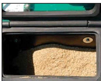
Tolva sembradora integrada de 11'3 kg. de capacidad
