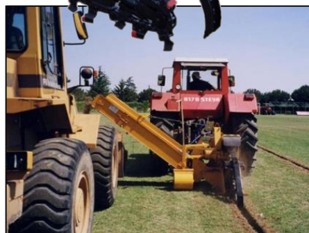
Zanjadora en posición lateral (con eje situado a 40 cm. de la toma de fuerza)
