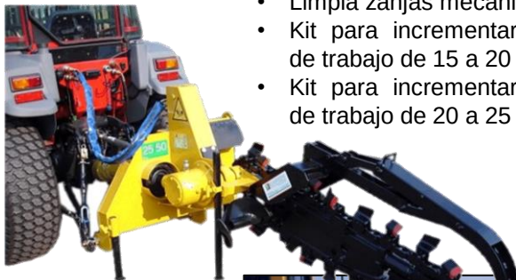
Zanjadora en posición lateral (con eje situado a 40 cm. de la toma de fuerza)
