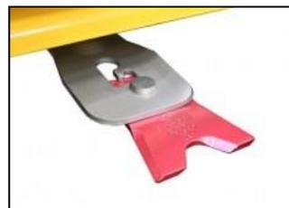
Corte rotativo mediante transmisión por correa
