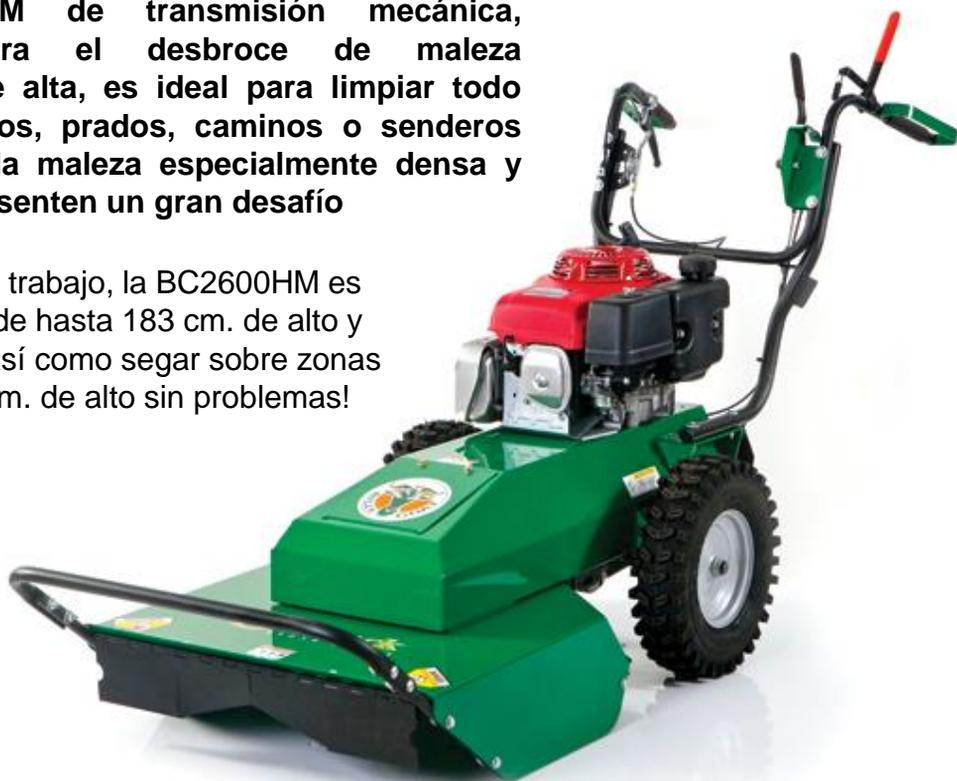
La tracción de la máquina (3 + 1) se consigue mediante un solo grupo sellado de alta resistencia que agrupa la transmisión y el diferencial evitan el uso de varillas y engranajes que puedan dificultar el trabajo de desbroce
