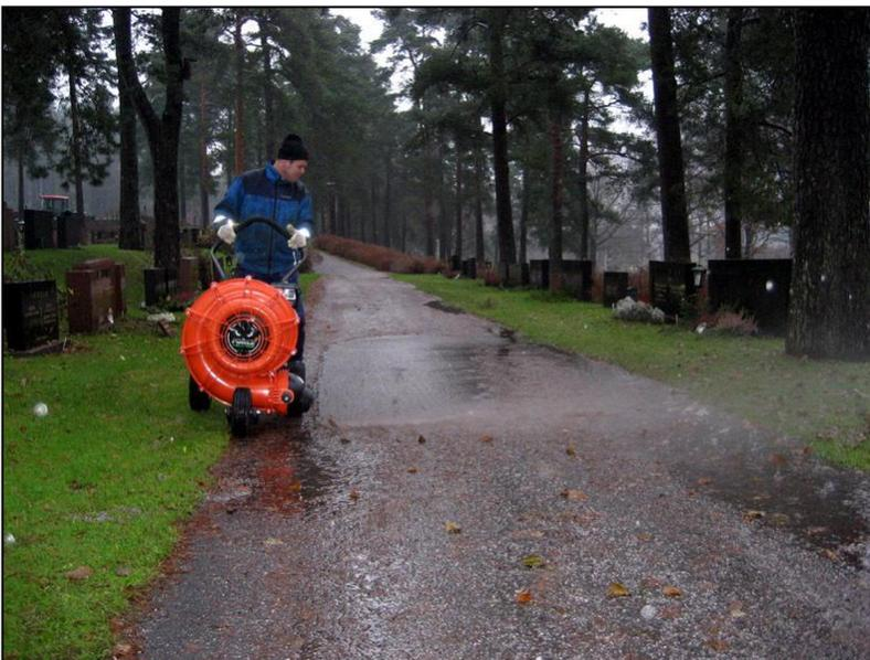
Máquinas a motor de empuje compuestas por una turbina y un sistema de dirección del aire que resultan muy útiles para acumular las hojas y otros desechos del jardín (incluso latas y botellas de cristal) en una zona concreta para posteriormente pasar con el aspirador y no tener que moverse con éste por todo el parque (¡muy útiles también para extraer los residuos de lugares especialmente difíciles como son por ejemplo de debajo de un banco, de debajo de vehículos, etc.).
