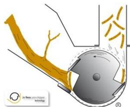
Sistema de triturado mediante 2 cuchillas de acero endurecidas + contra-cuchilla (reversible 4 lados, mod. M200)
