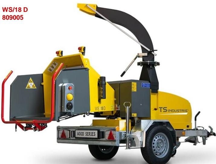
**WS/18 D:** Con remolque con freno de inercia completamente galvanizado y robusto, para los trabajos más exigentes, con lanza de enganche de altura regulable
