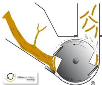
Sistema de triturado mediante 2 cuchillas de acero endurecidas + contra-cuchilla (reversible 4 lados)
