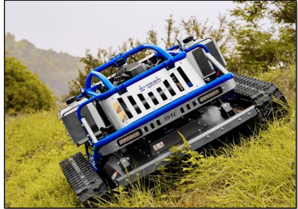
**El grupo siega** está diseñado para reducir la potencia requerida; la cuchilla es accionada directamente desde el motor por medio de una correa y se desacopla por medio de un embrague electromagnético.
