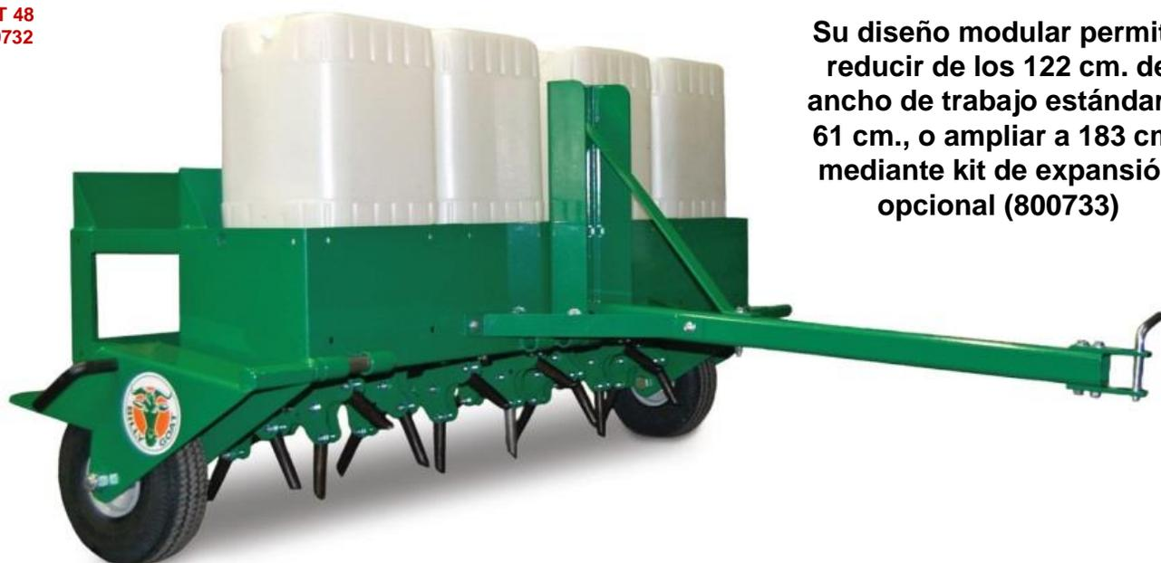
**Su diseño modular permite reducir de los 122 cm. de ancho de trabajo estándar a 61 cm., o ampliar a 183 cm. mediante kit de expansión opcional (800733)**
