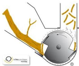
Sistema de triturado mediante 2 cuchillas de acero endurecidas reversibles + contra-cuchilla (reversible 4 lados)
