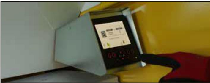
Entre otras cosas, el TS.Cockpit mide el voltaje de la batería y gestiona la retirada del gas de escape. Mediante la visualización de códigos de error, realiza un diagnóstico inteligente de la máquina. Se pueden detectar fácilmente las necesidades de servicios adicionales y cambios de aceite, así como los ajustes de la reducción de CO2.
