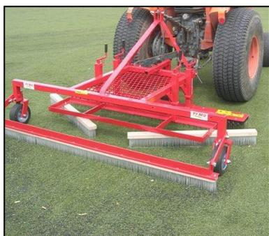
Compuesto de 4 barras de acero con cepillos fabricados con material indeformable que respetan la configuración del césped artificial sin deteriorarlo
