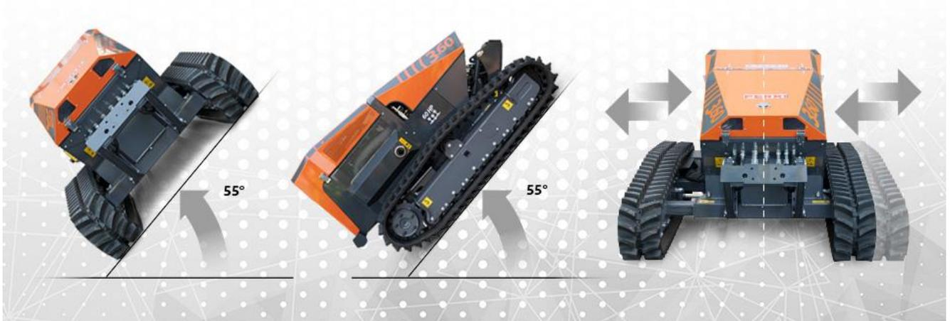
El innovador diseño a baricentro bajo permite trabajar con una inclinación de hasta 55°. Gracias a una distribución óptima del peso y a un centro de gravedad bajo, la iCUT es capaz de operar en ángulos de pendiente en todas las direcciones de hasta 55°, proporcionando un agarre y una tracción óptimos en todas las condiciones de trabajo
