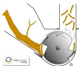
Sistema de triturado mediante 2 cuchillas de acero endurecidas + contra-cuchilla (reversible 4 lados, mod. H300/500)
