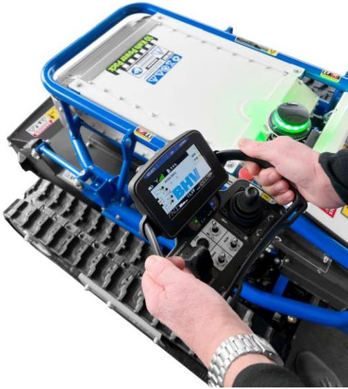
**Mando a distancia** equipado con tecnología AFA (*automatic frequency adjustment* o ajuste de frecuencia automático), que permite buscar y encontrar (siempre) una frecuencia libre de interferencias de la señal de radio.
