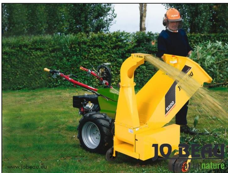
Diseñada especialmente como trituradora móvil con eje simple para 16 cv de potencia mínima y para diámetros de rama de 8 a 10 cm. (dependiendo del tipo de madera) dando lugar a astillas de madera triturada de altísima calidad.
