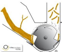
Sistema de triturado mediante 2 cuchillas de acero templado + contra-cuchilla
