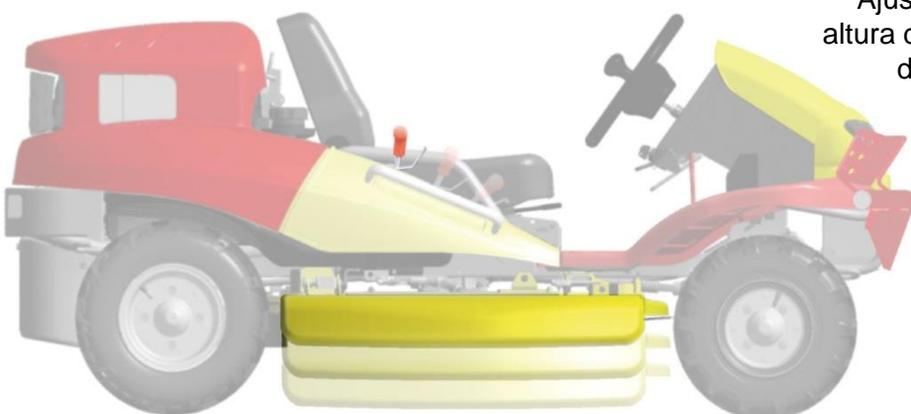
Ajuste de la altura de corte deseada
