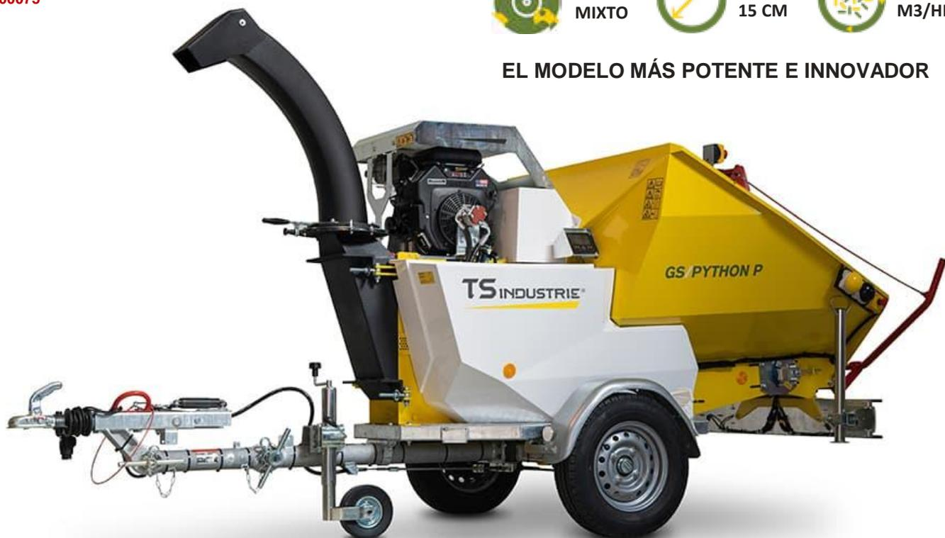
1.- Rotor mixto patentado con 8 martillos (con cabezales desmontables) y 4 cuchillas
