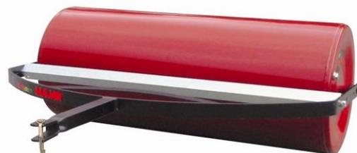
**130/180:** Rodillos planos apisonadores para arrastre o a 3 puntos del tractor (modelos de 130 cm. rellenables para sobrepeso con 150 lt. de agua)
