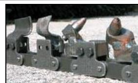
**Cadena mixta (punteros + cuchillas) (para ancho de zanja de 11 cm.)**
