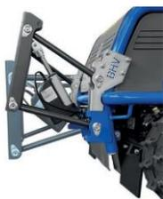
**Sist. eléctrico de alzamiento trasero para accesorios:** Sistema de alzamiento de conexión rápida para accesorios (pala de nieve, etc); funciona eléctricamente y a través del mando a distancia y no precisa de herramientas para su instalación (se monta en la parte trasera del X-ROT)
