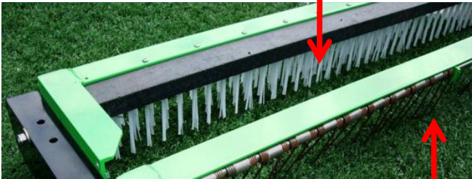
Púas de acero descompactadoras
