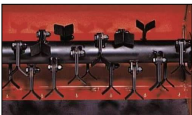
Sistema de corte de martillos flotantes “Y” contra rotura por impactos
