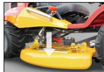
Ajuste de la altura de corte deseada
