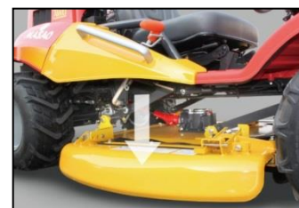
Ajuste de la altura de corte deseada
