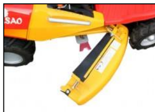
Corte rotativo mediante transmisión por correa
